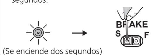
③ Después de pulsar el botón del freno, la lámpara de confirmación parpadea el número de veces especificado mostrando el nuevo ajuste, se mantiene encendida durante dos segundos y después se apaga.
