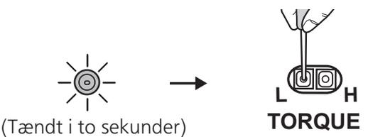
③ Når du har trykket på drejningsmomentknappen, blinker bekræftelseslampen det angivne antal gange for at vise den nye indstilling, forbliver tændt i to sekunder og slukker så.
