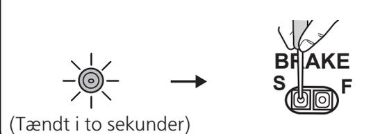
③ Når du har trykket på bremseknappen, blinker bekræftelseslampen det angivne antal gange for at vise den nye indstilling, forbliver tændt i to sekunder og slukker så.
