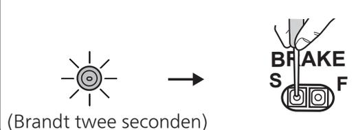
③ Na het indrukken van de remknop knippert het bevestigingslampje het aangegeven aantal keren om de nieuwe instelling te laten zien, blijft het twee seconden aan en gaat dan uit.
